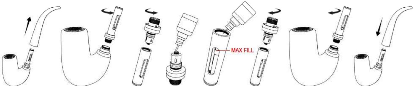
Es importante "preparar" un nuevo atomizador antes del primer uso. De no hacerlo puede causar que la bobina del atomizador se sobrecaliente, lo que resulta en un sabor quemado y, a veces daño irreversible a la cabeza del atomizador que requiere un reemplazo antes de tiempo. Retire la boquilla tirando directamente, desenroscar y quitar el tanque, desenroscar la base del tanque para ver la cabeza del atomizador.
